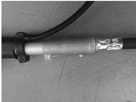
**ATTENTION:** Si l'insertion du tuyau flexible est difficile, le bout carré de l'axe flexible pourrait ne pas bien être logé dans le joint de l'arbre d'entraînement. Ne forcez pas afin d'éviter des dégâts sur l'extrémité de l'axe flexible. Répétez la même procédure jusqu'à ce que l'axe flexible et le tuyau soient bien ajustés.
