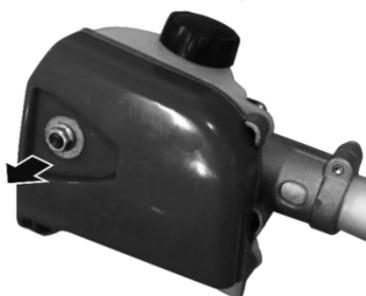
Placez le guide chaîne de façon à ce que la goupille de sécurité de la chaîne vienne s'engager dans les dents de celle-ci. Veillez à ce que le sens du mouvement de la chaîne de coupe soit correct. Installez la protection de la chaîne et serrez la vis de fixation
